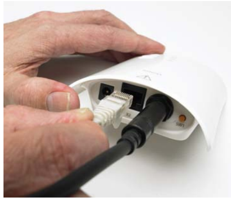
Verbinden Sie das Anschlusskabel Ihres Personrufsystems mit dem AUX-Anschluss X2.
